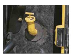
Capot fermé, des contrôles rapides du niveau d'huile moteur et du regard de niveau de liquide de refroidissement peuvent être effectués par les portes d'entretien latérales.
