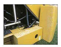
Le capot inclinable offre un très bon accès au compartiment moteur et, au besoin, l'ensemble du capot peut être déposé avec les points de levage intégrés.
