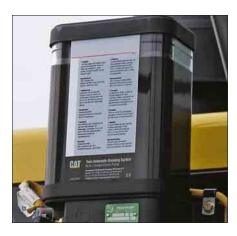
Graissage automatique. La durée de l'entretien quotidien est réduite et les immobilisations pour des réparations imprévues dues à un graissange inapproprié sont limitées grâce au système de graissage automatique Caterpillar (en option). Le graissage précis des axes et des bagues à intervalles spécifiques prolonge la durée de vie des composants et réduit la contamination du sol due à un graissage excessif.
