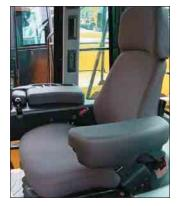
Les commandes d'équipement montées sur le siège à suspension pneumatique réduisent les vibrations verticales qui passent par le plancher de la cabine.
