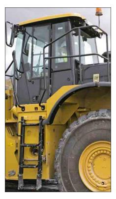
Accessoires pour le nettoyage du pare-brise. Les accessoires de nettoyage du pare-brise en option incluent des marchepieds et des mains courantes supplémentaires afin de faciliter l'accès pour le nettoyage des vitres avant.
