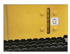
Regards de niveau. Bien protégés tout en étant facilement visibles, les regards de niveau pour l'huile de transmission, l'huile hydraulique et le liquide de refroidissement moteur simplifient les contrôles journaliers et limitent les risques de contamination des circuits.
