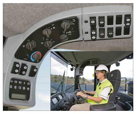
arrière et le bouton de montée des rapports/rétrogradation, permettant à la main gauche de rester sur le volant de direction à tout moment. La colonne de direction s'incline à 35° et permet un réglage téléscopique de 100 mm.
